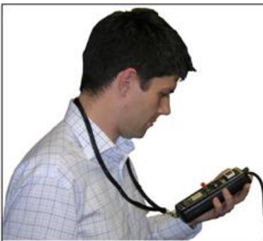
コイル先端部を、ソケット部に完全に挿入した段階でLCDディスプレイの表示を読む。
