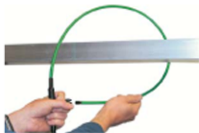
DC電流の流れる対象物に巻き付ける。
